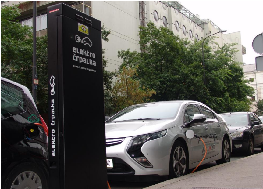
SMARTV2G Feldtest mit Elektrofahrzeugen an einer intelligenten Wechselstromladestation in Ljubljana
